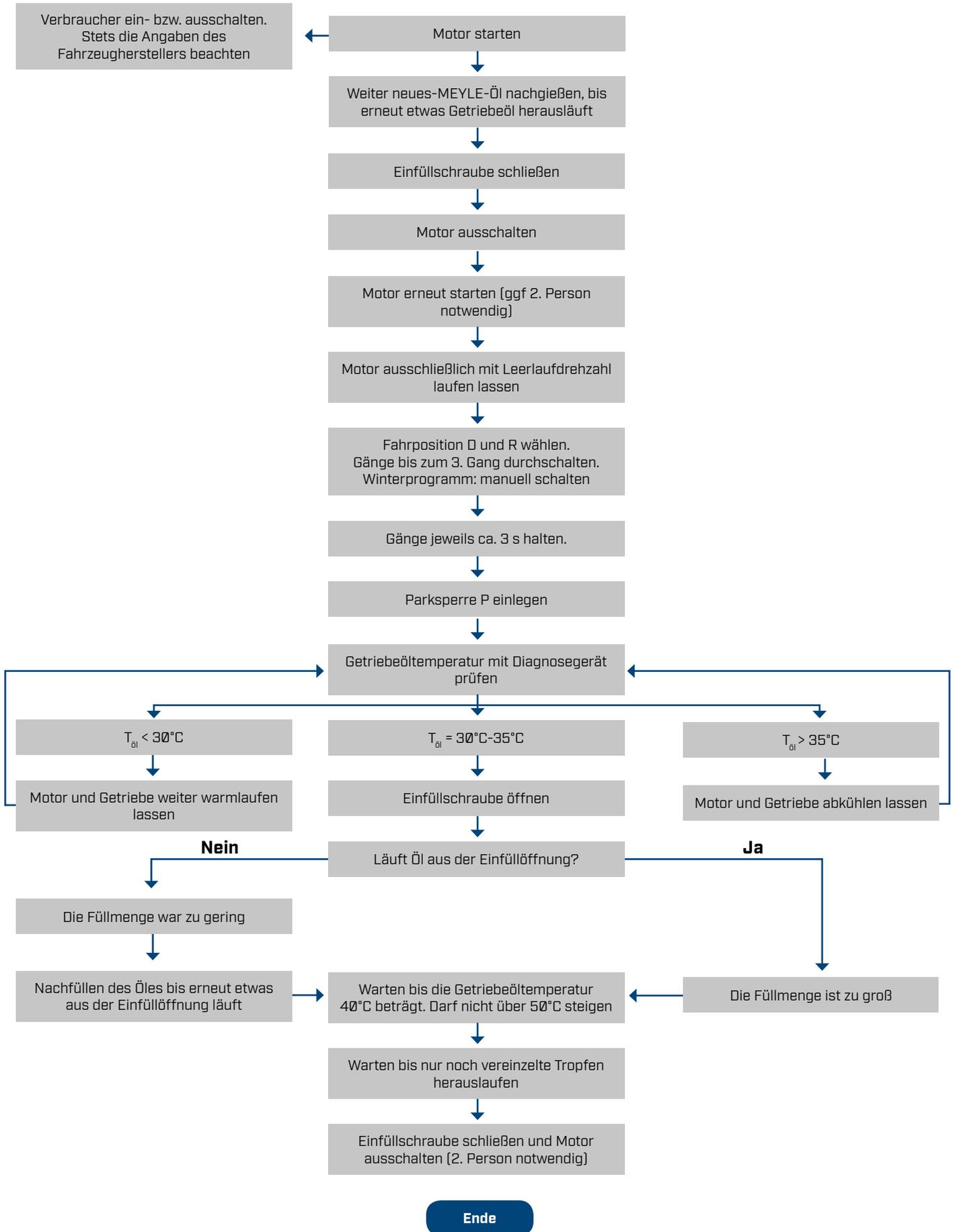
**Achtung:** Bei diversen Getriebetypen kann ein Bypassventil verbaut sein, welches den Ölkreislauf zum Ölkühler öffnet oder verschließt. Deshalb sollte bei einer ausreichenden Probefahrt die Getriebeöltemperatur mindestens  $75^{\circ}\text{C}$  erreichen. Nach der Probefahrt das Getriebe abkühlen lassen und den Ölstand erneut kontrollieren ggf. korrigieren.
